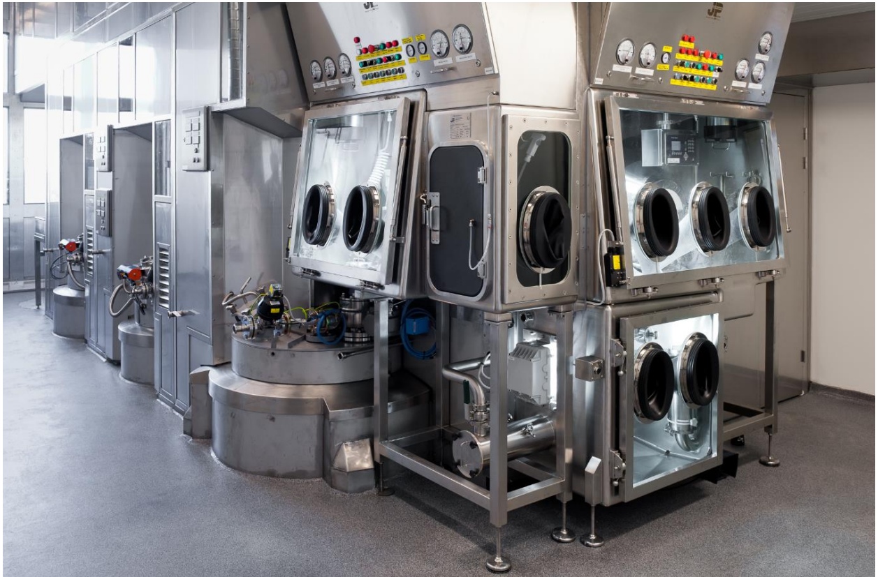
Kuva 2. Hanskakaappi kemikaalien suljettuun käsittelyyn.
